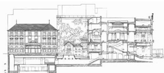
SECCIÓN LONGITUDINAL POR LA AMPLIACIÓN SUBTERRÁNEA
